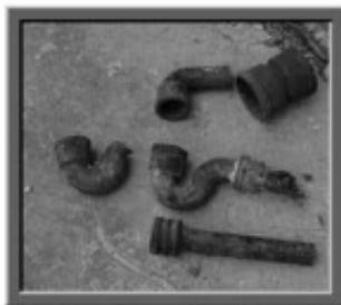
Foto 66.- Algunos tubos de la instalación sanitaria de fierro fundido que se utilizaron en Vista Hermosa y que se retiraron en la restauración de 1969-1970.
