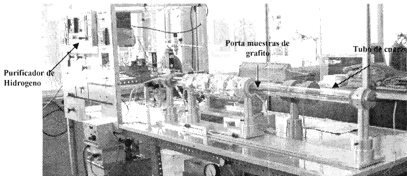
Figura 3.7 Sistema utilizado para realizar los recocidos.
