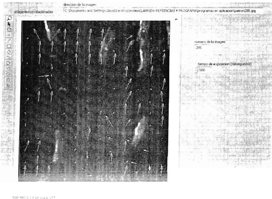
Figura 7.24. Programa de LabVIEW que muestra las imágenes correlacionadas donde nosotros solamente ingresamos el tiempo de exposición
