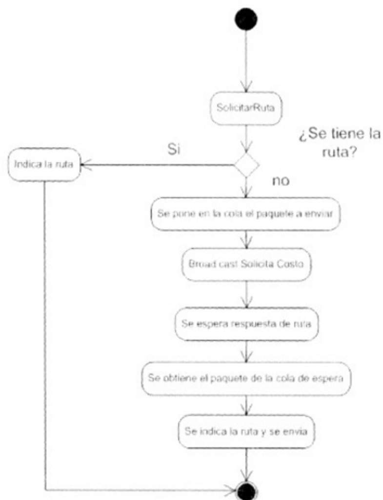
Figura 2.1: Este diagrama ilustra el procedimiento de localización de una ruta
