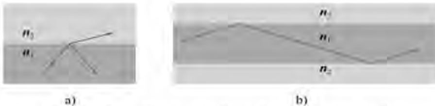
Fig. 1.7 a) Luz incidiendo sobre la interfaz entre dos medios de índices de refracción n_1 y n_2 tal que n_1 > n_2 . b) Guía de onda formada emparedando un material de índice de refracción n_1 entre dos capas de material de índice de refracción n_2 , tal que n_1 > n_2 . La guía de onda se basa en el fenómeno de reflexión interna total.
