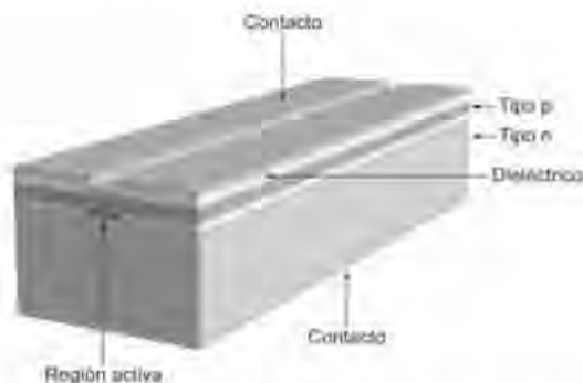
Fig. 6.6 Diagrama del láser con contacto de franja o stripe . El dieléctrico aísla eléctricamente a la heteroestructura del contacto superior de oro, excepto en la región de la franja libre de dieléctrico. La región activa queda entonces confinada eléctricamente por dicha franja.
