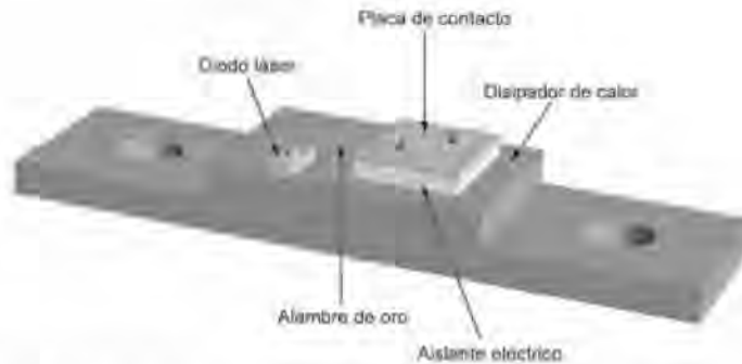
Fig. 6.2 Láser de semiconductor montado en un disipador de calor de cobre, el cual funciona además como electrodo inferior.
