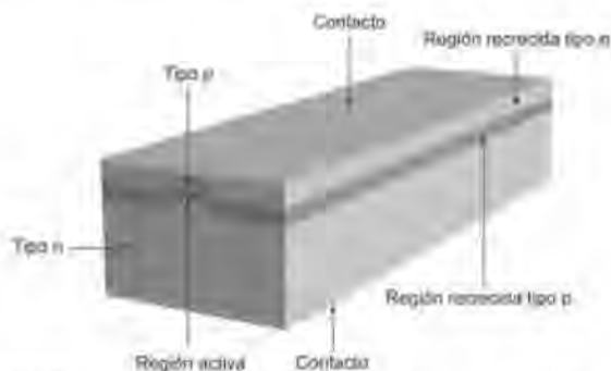
Fig. 6.10 Diagrama de un láser recrecido con stripe de meseta. Al polarizar directamente la región activa, la unión p-n de la región recrecida se polariza inversamente impidiendo el paso de corriente a través de la misma. La corriente circula solamente por la región de la meseta.
