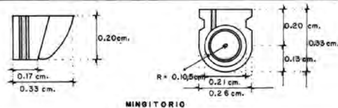
Diseño de los muebles del sanitario ecológico seco.
