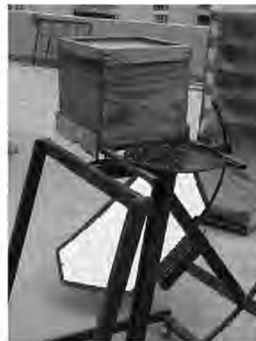
Propuesta de DESICA para ahorro de combustible vegetal o gas. Estufa solar diseñada y probada por el Ing Fritche.
