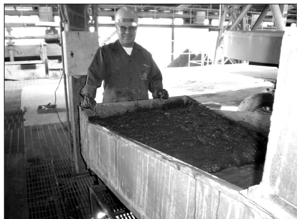
Figura 3. Fotografía de la primera celda de flotación MAZ trabajando a nivel industrial en la compañía Negociación Minera Santa María de la Paz y Anexas S.A. de C.V.
