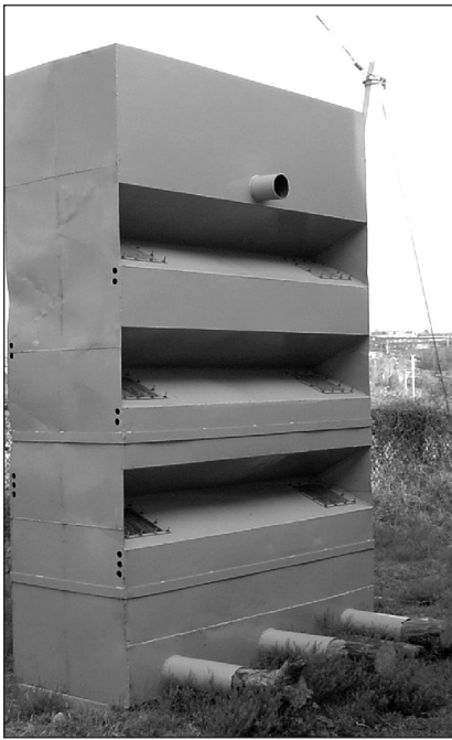
Figura 4, Primer prototipo a nivel industrial de la celda vertical MAZ, para la compañía minera Sonny. (Actualmente se encuentra en el Instituto de Metalurgia)
