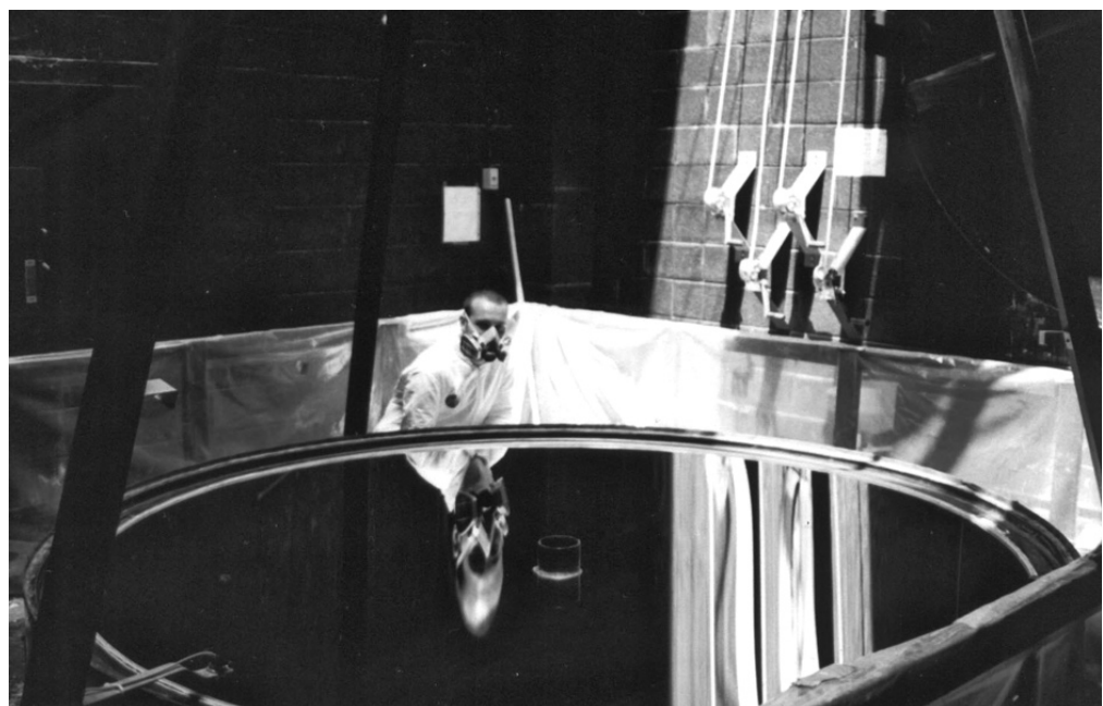
Figura 4. Espejo de mercurio líquido del Purple Crow Lidar, University of Western Ontario, Canadá.
