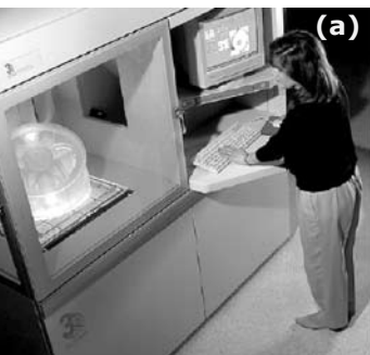
Figura 2. Sistemas RP: a) SLA de 3D Systems, b) 3DP Z Corp, c) InVision LD 3-D.
