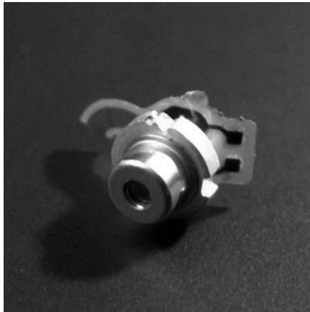
Diodo láser de formato blu-ray
