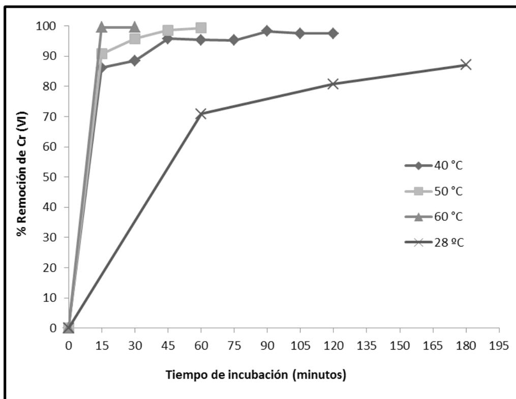
Figura 3.- Efecto de la temperatura sobre la bioadsorción de Cr (VI).
