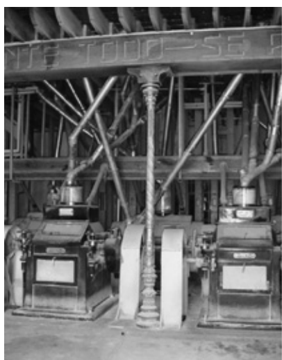
Imagen 9. Maquinaria de molino de cilindro del siglo XIX y cañería de bajada modular localizada en fábrica harinera de Guadalupe, Zacatecas, Imagen: Paola Corral
