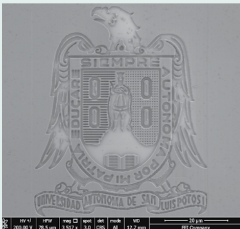
Figura 9. Logo de la UASLP esculpido por medio de nanolitografía de haz de electrones.
