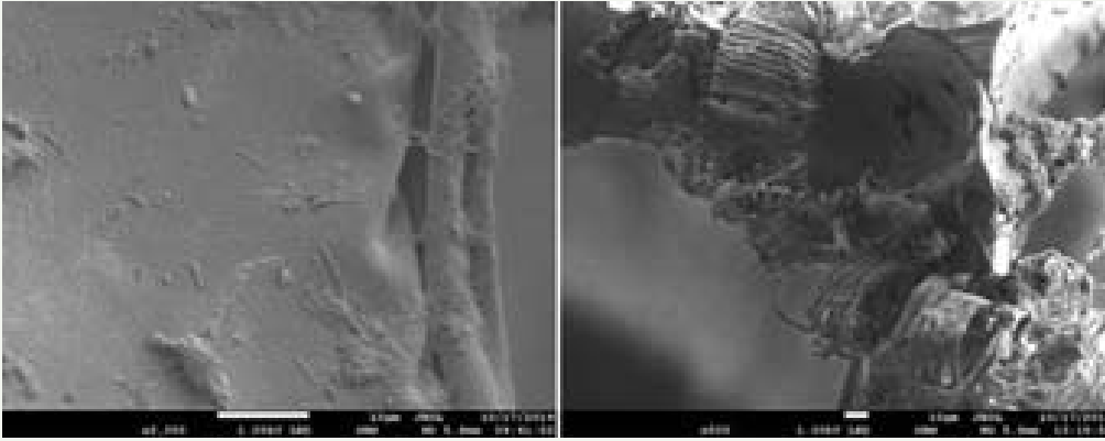
Figura 3. Microscopía electrónica de una esponja de poliuretano recubierta de polipirrol y polianilina sobre la cual se ha inmovilizado una biopelícula (capa de un consorcio de microorganismos).
