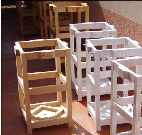
**Fotografía 7-9.** En la parte izquierda de la imagen se aprecia al colector de precipitación sin pintar. En la misma imagen se observan algunas otras estructuras que ya han recibido el recubrimiento de pintura.
