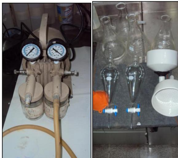
**Fotografía 7-19. Material de laboratorio utilizado para la separación del aceite presente en las muestras de precipitación.**
