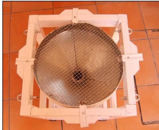
**Fotografía 7-10.** Imagen de planta de la estructura en la cual se aprecia como es sujetado del embudo a la estructura de madera.
