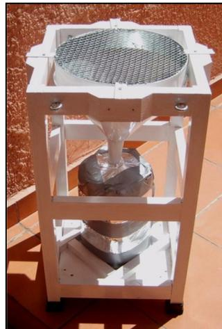
**Fotografía 7-11.** Imagen de un colector de precipitación terminado y listo para ser puesto en operación.
