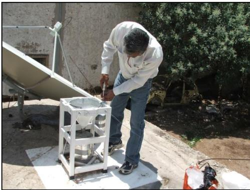
**Fotografía 7-15.** Remoción del embudo que se encuentra sujetado a la parte superior del colector de precipitación
