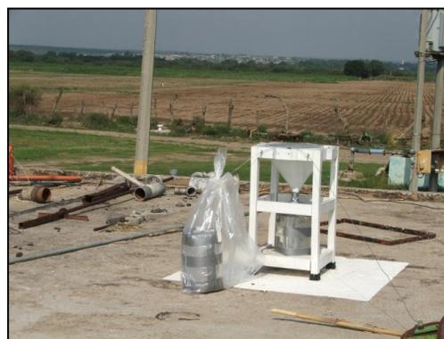
**Fotografía 7-18.** Termina el proceso de colecta de muestra. La muestra recolectada se encuentra dentro de la bolsa y el bidón nuevo se encuentra en la estructura.
