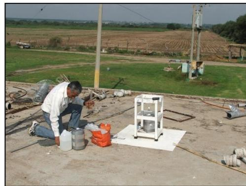
**Fotografía 7-16.** Preparación del nuevo bidón. Se le coloca aceite mineral pesado para formar una película que evite la evaporación del agua.
