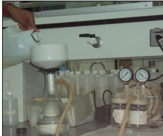
**Fotografía 7-20 (Izquierda). Dispositivo para la separación del agua y el aceite.**
