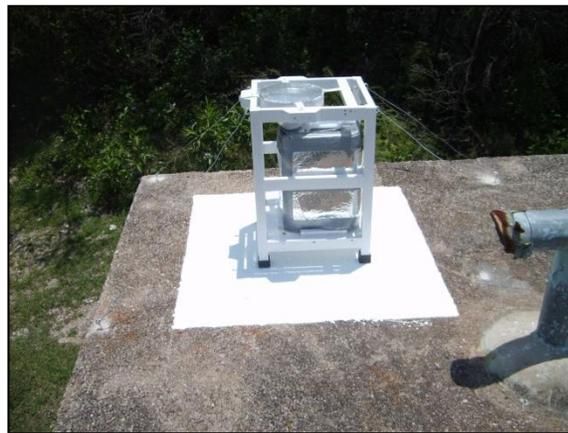
**Fotografía 7-12 (Izquierda).** Proceso previo a la instalación del colector de precipitación, donde la superficie fue cubierta con una capa de pintura calor blanco.
