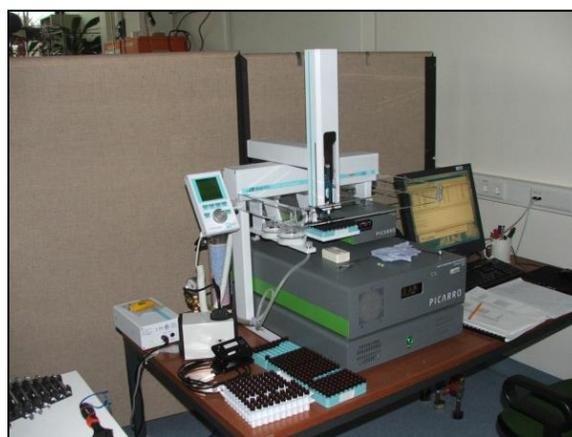
Fotografía 7-28. Analizador de Isótopos del laboratorio de Hidrología Isotópica de la IAEA. En la parte superior del Analizador de Isótopos L1102-i (en color gris) se observa el automuestreador (en color blanco).
