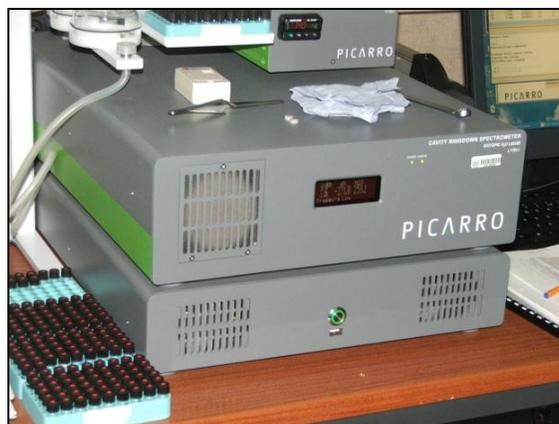
Fotografía 26. Vista frontal del Analizador de Isótopos marca Picarro modelo L1102-i.
