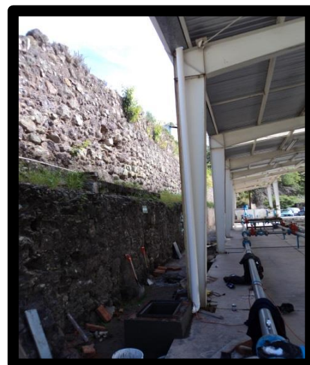
Figura 7. Sistema de captación del agua de lluvia instalado en el Laboratorio de Hidráulica de la Universidad de Guanajuato.
