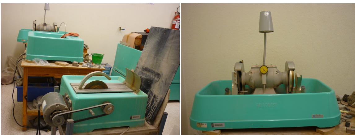
Figura 1.1. Cortadora de disco de diamante (izquierda) y cortadora/desvastadora (derecha) de la marca HILLQUIST, utilizadas para la elaboración de láminas delgadas.
