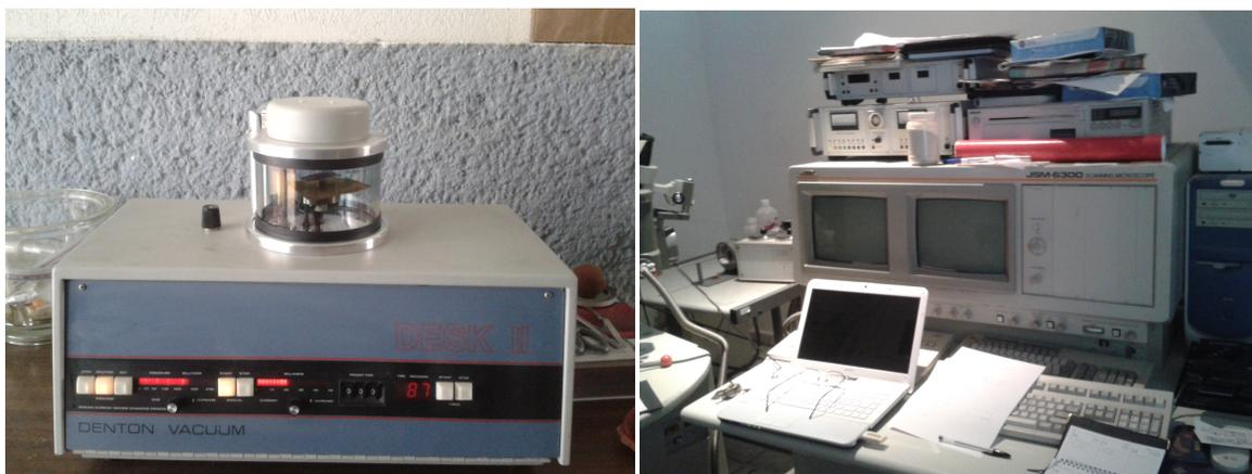
Figura 1.2. Ionizadora marca DENTON VACUUM – Desk II (izquierda) y Microscopio Electrónico de Barrido (derecha).
