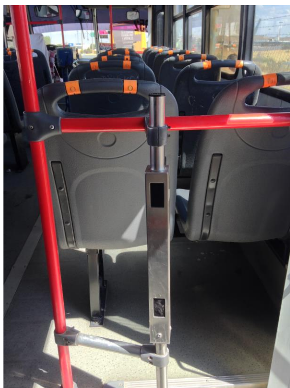
Fotografía 7. Sensores infrarrojos para registro de ascenso y descenso de pasaje.
