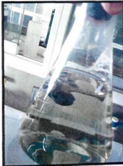
Figura 22. Adsorción total del colorante azul remazol con una concentración inicial de 100 ppm. pH 3, T 25°C
