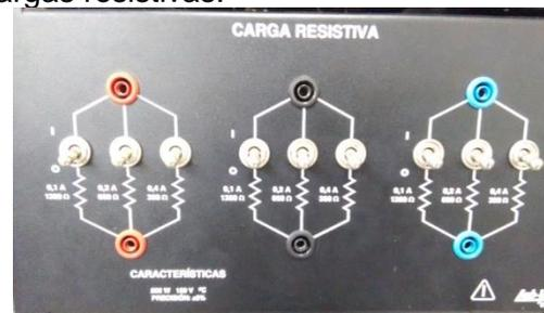
Figura 8. Módulo de carga resistiva 8611
