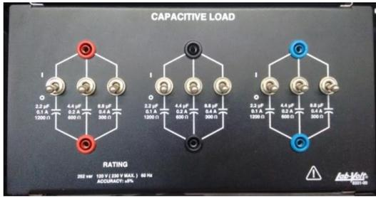
Figura 9. Modulo de carga capacitiva 8331
