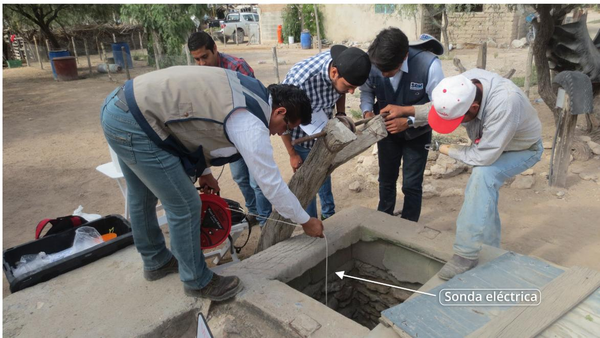
Figura 31. Mediciones de profundidad y nivel estático de una noria con la sonda eléctrica.
