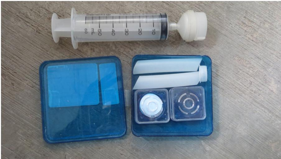
Figura 40. Jeringa de plástico y membrana de acetato de celulosa para filtrar.
