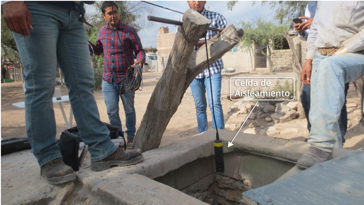
Figura 34. Celda de aislamiento de la sonda multiparámetros.
