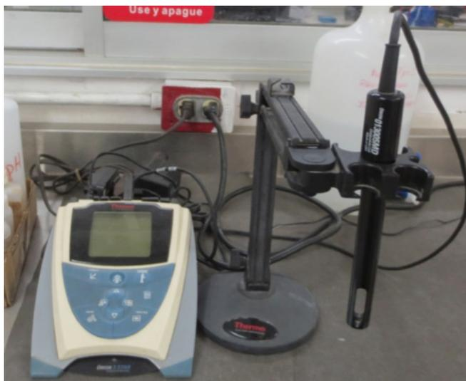
Figura 50. Conductímetro Thermo scientific modelo ORION 3 Star.
