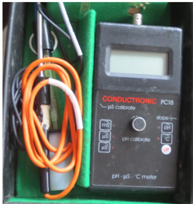
Figura 36. Conductímetro PC 18.
