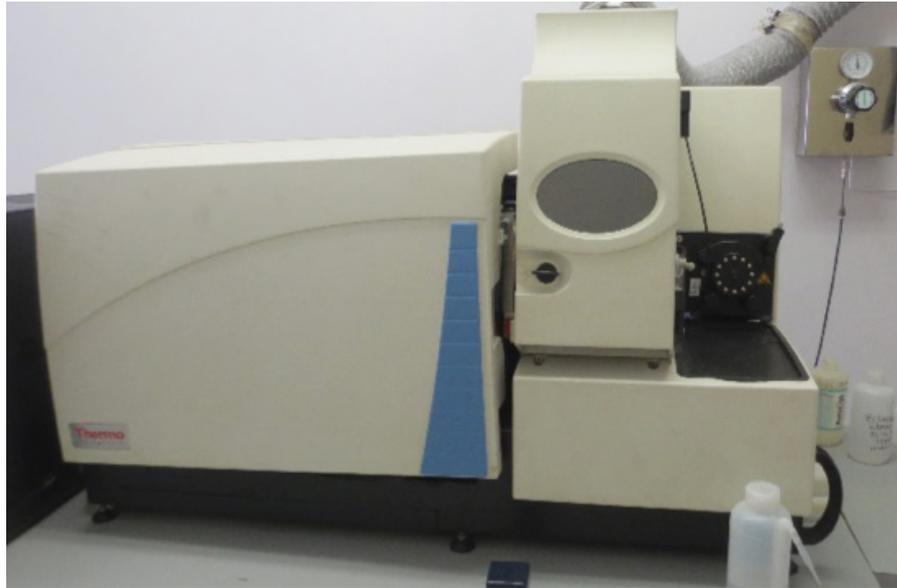
Figura 47. Espectrómetro de masas ICP-MS, X Series II.
