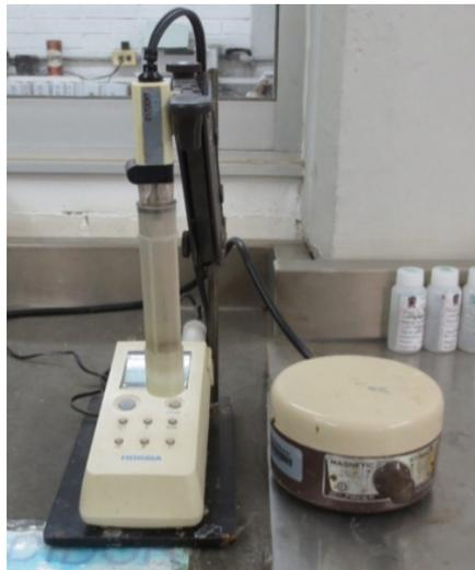
Figura 49. Potenciómetro HORIBA.
