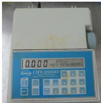
Figura 48. Instrumento espectrofotométrico DR 2000 de HACH.
