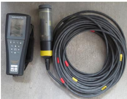
Figura 32. Sonda multiparámetros Professional Series YSI.
