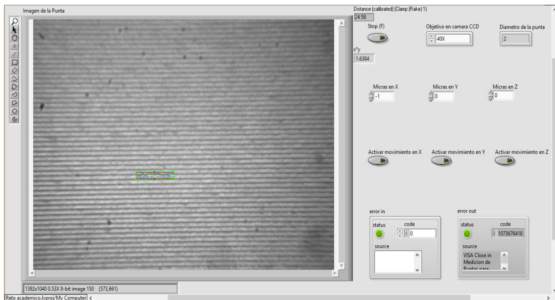
Figura 294. Panel frontal con medición de rejilla de difracción de 600 líneas por milímetro.
