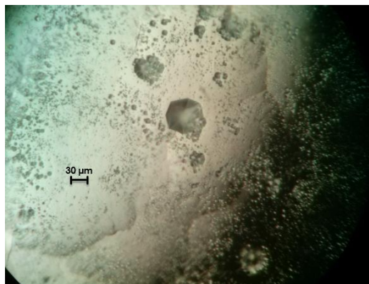
Figura 173. Pits generados en oblea de silicio mediante ataque químico con KOH.
