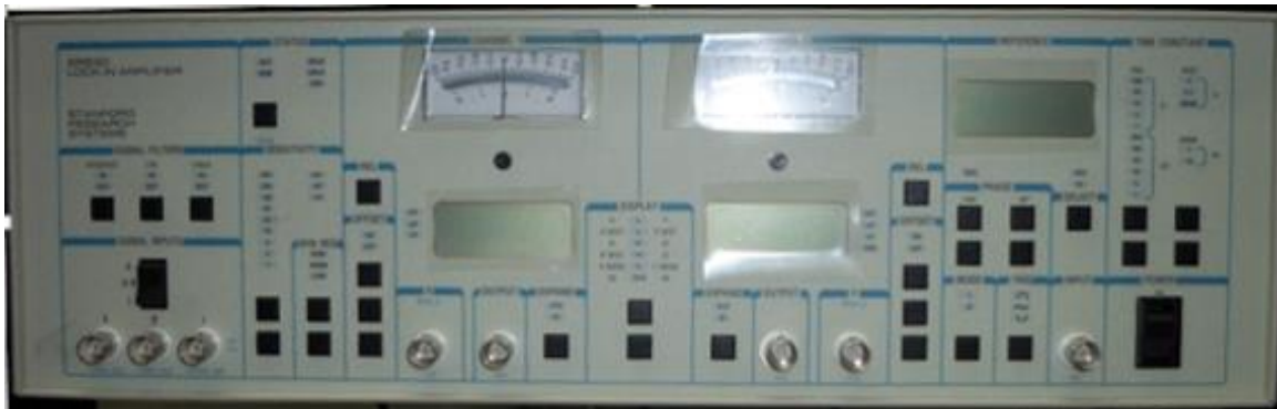
Figura 61. Caratula frontal del Amplificador Lock-In modelo SR530.
