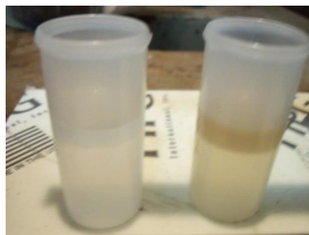
Figura 282. Soluciones preparadas para el adelgazamiento de fibra óptica.
