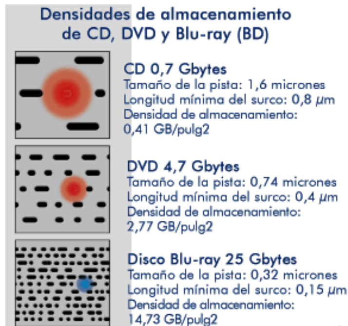
Figura 121. Comparación del tamaño de las estructuras de CD, DVD y Blu-ray. [59]
