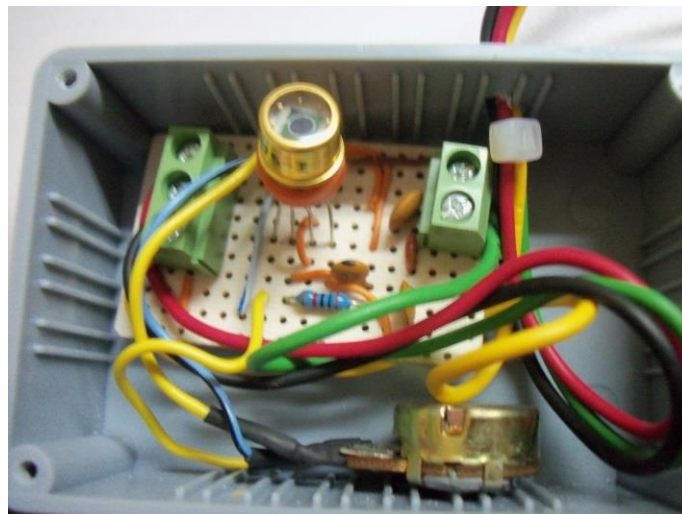
Figura 15. Electrónica desarrollada para el fotodiodo detector.
