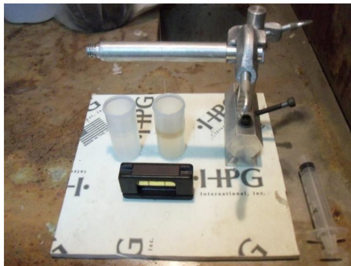
Figura 287. Sistema de adelgazamiento de puntas de fibra óptica nivelado.
