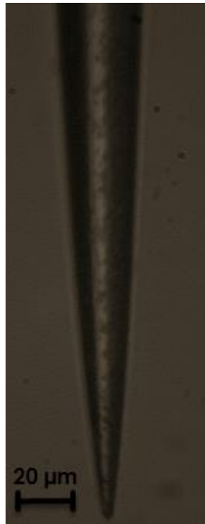
Figura 4. Punta de fibra óptica, utilizada para el escaneo del microscopio de barrido de campo cercano desarrollado en este trabajo.
