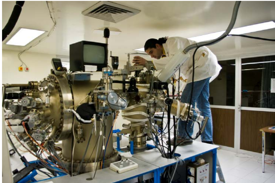
Figura 3.1: Sistema de crecimiento por Epitaxia por Haces Moleculares del IICO-UASLP.
