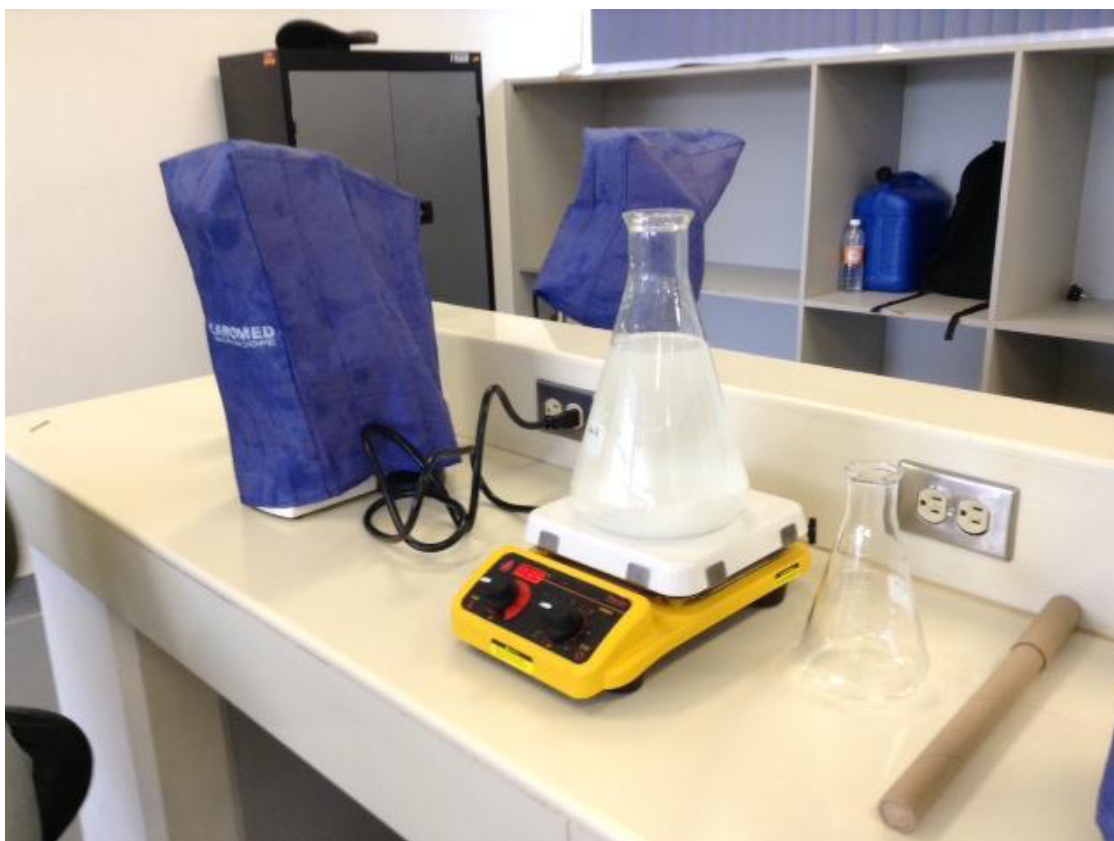
Figura 4. Preparación de solución salina saturada. La preparación se realiza con NaCl y agua destilada, utilizando para homogenizar la mezcla una placa térmica con agitador magnético.
