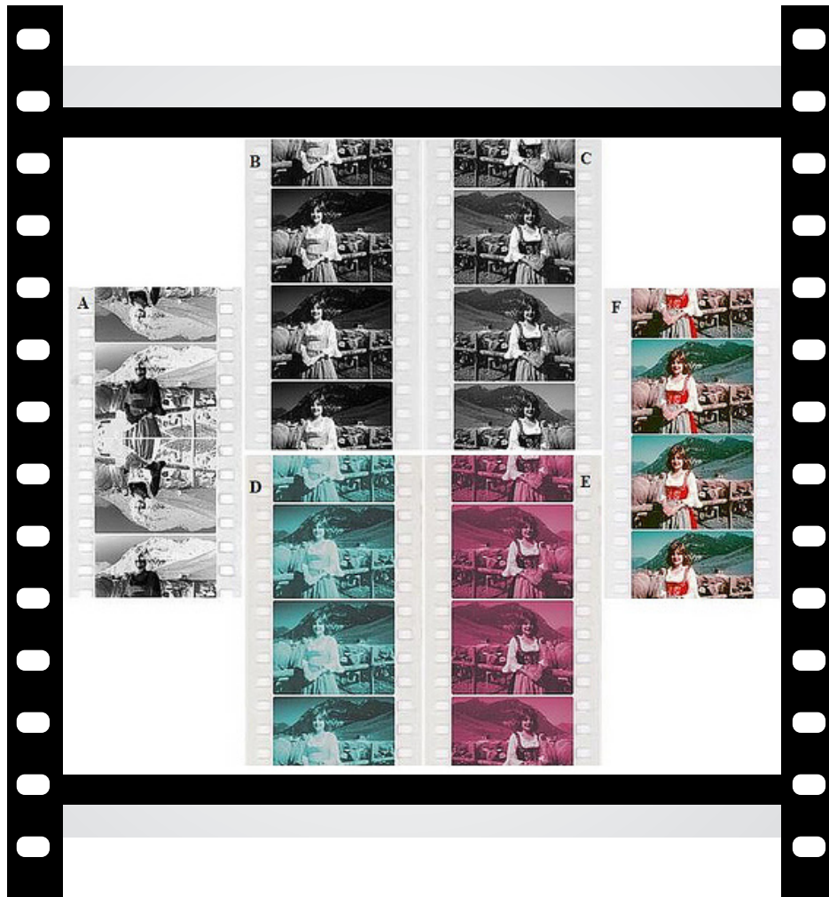
Figura 4.5. Proceso del Technicolor , basado en el método de síntesis sustrativa. A diferencia de los demás sistemas de color, el Technicolor no necesitaba un equipamiento de proyección especial.
