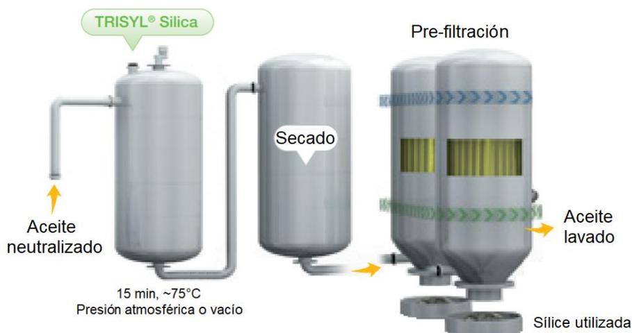
Figura 4.16 Diagrama de proceso del tratamiento con hidrogeles de sílice y secado a vacío. Adaptado de (Grace & Co., 2011).
