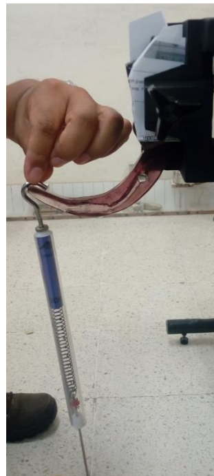
Figura 6 Medición de resistencia a la tracción de prototipo Hybrid 1.0 Laboratorio de Física de la Universidad Autónoma de San Luis Potosí
