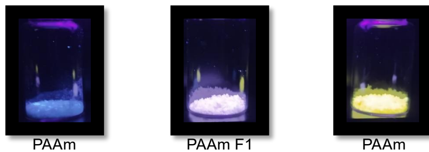
Figura 4.1 Fluorescencia en sólido del hidrogel pulverizado de la poliacrilamida pura (Izquierda) e impregnada con F1 (Centro) y F2 (Derecha), bajo luz UV 365 nm.
