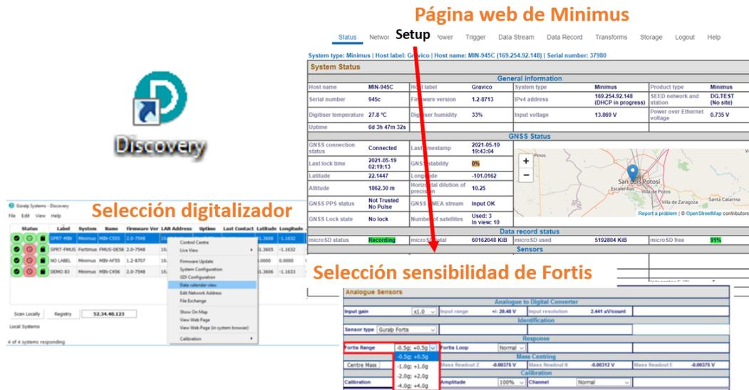
Figura 5.6: Imágenes de pantalla para acceder al estado del digitalizador Minimus y del acelerómetro Fortis usando el programa Discovery de Guralp<sup>54</sup>.
