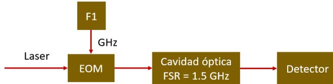
Figura 5.7: Diagrama del montaje general para la caracterización del EOM.
