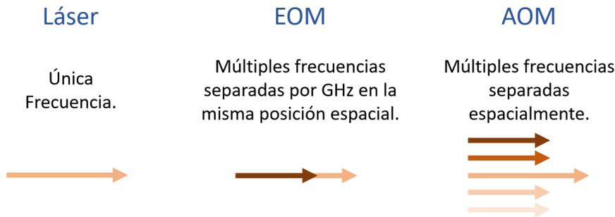
Figura 5.5: Esquema principal del funcionamiento de la caja de modulación.
