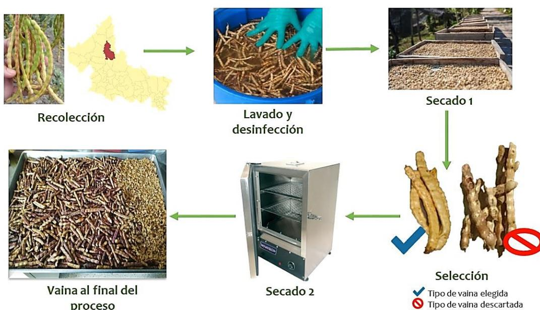
**Figura 4.** Proceso de lavado, desinfección, selección y secado de la vaina de mezquite.
