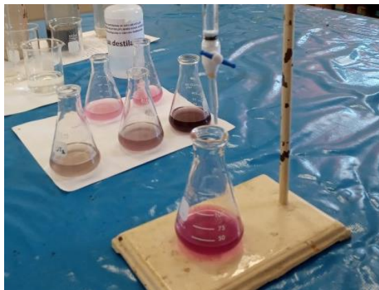
Figura 8. Determinación de dureza total por titulación complejométrica.
