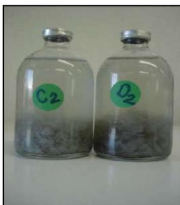
**Figura 11.** Botellas serológicas de 120 ml con celulosa sólida (CS) como fuente de carbono.
