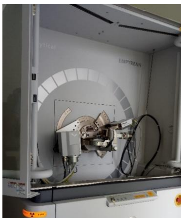
Figura 10. Difractómetro de rayos X.
