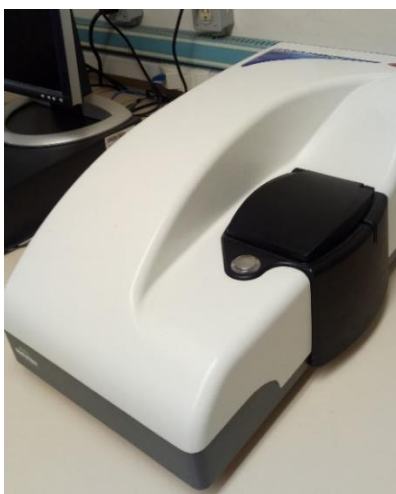
Figura 7. Equipo Malvern modelo Zetasizer Nano ZS.
