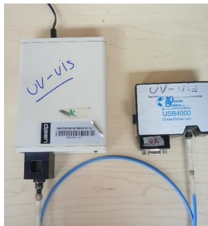
Figura 8. Equipo OceanOptics modelo S2000-UV-vis.
