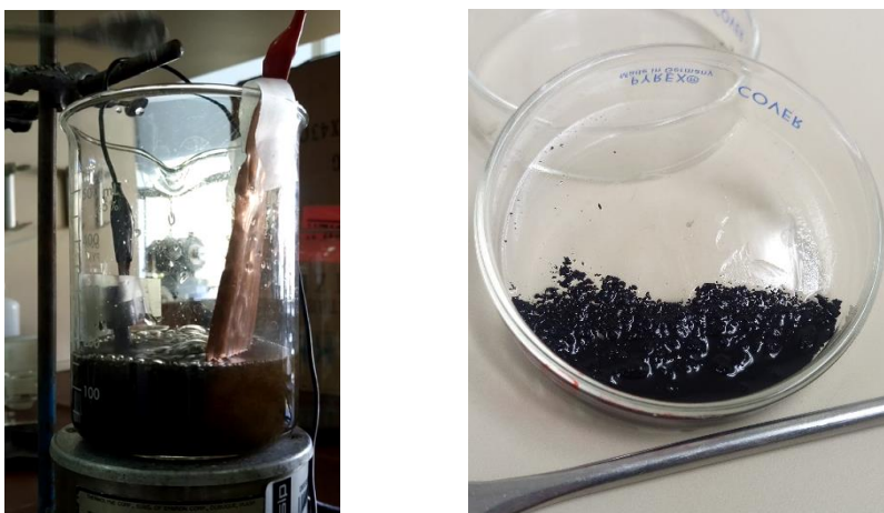
Figura 13. a) Síntesis de CuNPs por el método electroquímico, b) Proceso de secado para las CuNPs.
