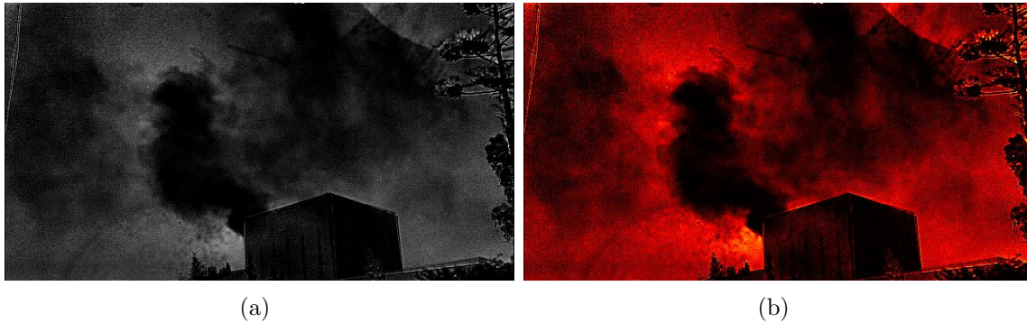
Figura 4.17: (a) Transmitancia resultante de la operación de imágenes para detección de \text{NO}_2 en la empresa Gyproc Saint-Gobain (b) en espacio de color.
