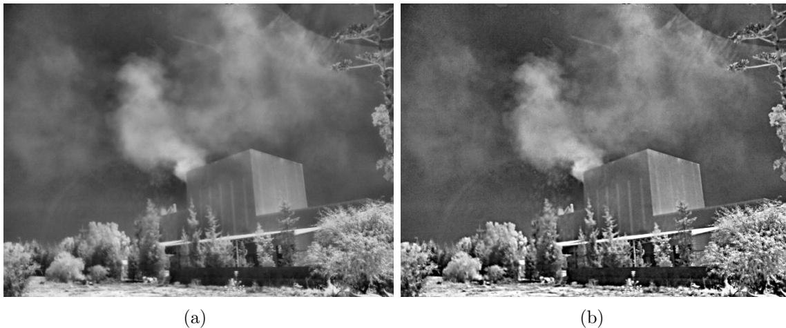
Figura 3.17: Afilado de imagen mediante filtros pasa-altos. (a) Imagen con ecualización de Histograma (b) Aplicación de filtro pasa-altos posterior al proceso de ecualización de histograma.
