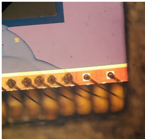
Figura 3.6: Aplicación de capa polimérica para protección de contactos metálicos (observados en la parte inferior).
