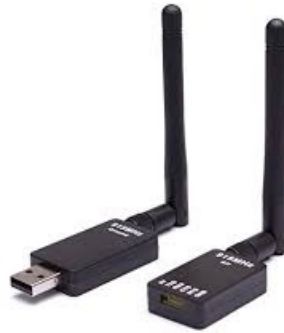
Figura 3.32: Modulo de radio telemetría para estación terrestre.
