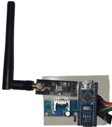
Figura 3.26: Sistema receptor mediante modulo NRF24 y Arduino nano.
