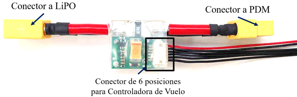
Figura A.4: Esquema de conexión de módulo de Telemetría a Controladora de vuelo.
