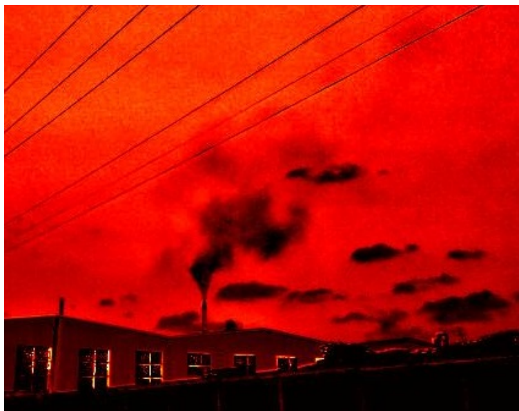
Figura 4.31: Transmitancia resultante de la operación de imágenes para detección de \text{NO}_2 en la empresa Tarimas y Maderas Durango .
