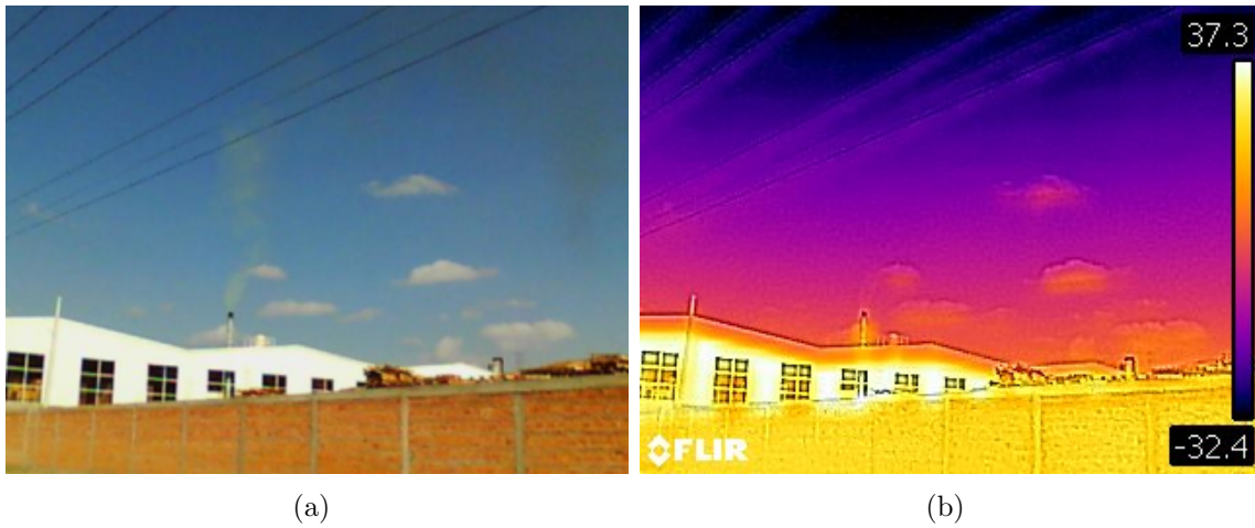
Figura 4.33: (a) Imagen térmica e (b) imagen óptica de la fuente de emisión de la empresa Tarimas y Maderas Durango .
