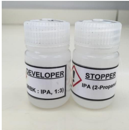
Figura 3.27. Developer y stopper usados para el proceso de revelado.
