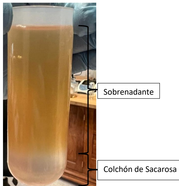
Figura 19. Colchón de sacarosa con el sobrenadante antes de la centrifugación (se tiene que ver una mezcla heterogénea).
