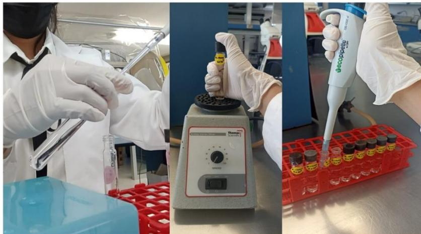
Fig. 19 Diluciones seriadas de *B. clausii*. Colocación de 1 mL de solución del tubo número 1 al 2, posterior agitación en vórtex y se repite procedimiento.
