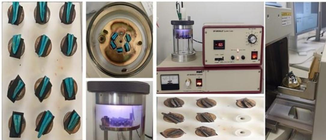
Fig. 29 Recubrimiento de oro. Las muestras se colocan primero dentro del Sputter coater para el recubrimiento y posteriormente se introducen en el MEB.
