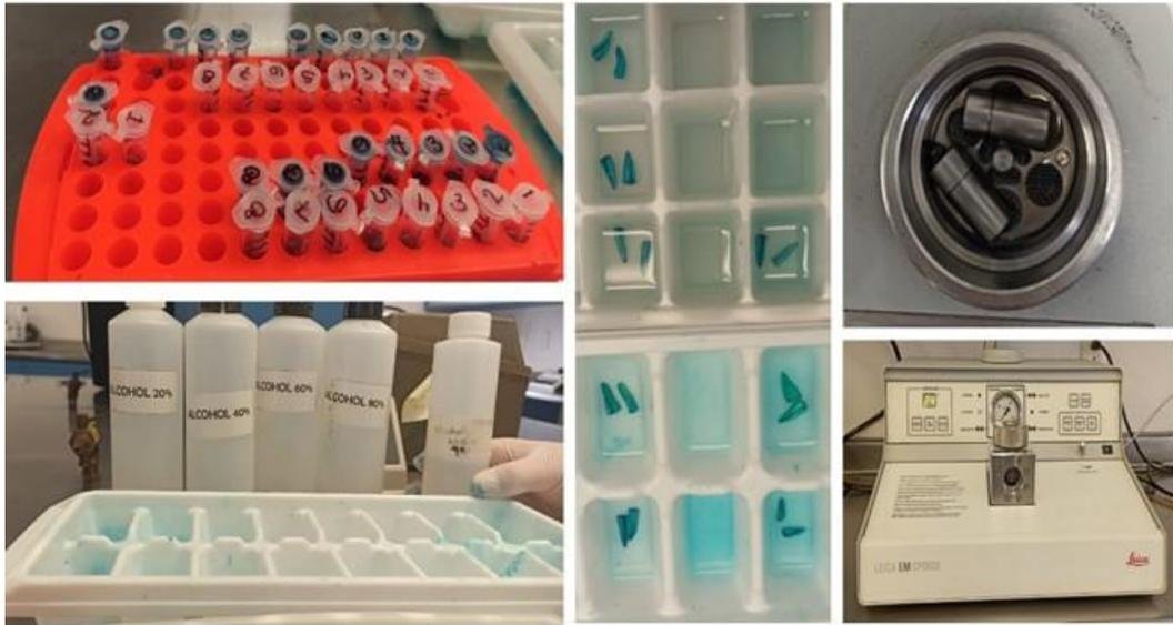
Fig. 28 Fijación de muestras, deshidratación en alcoholes a porcentajes crecientes y secado a punto crítico.
