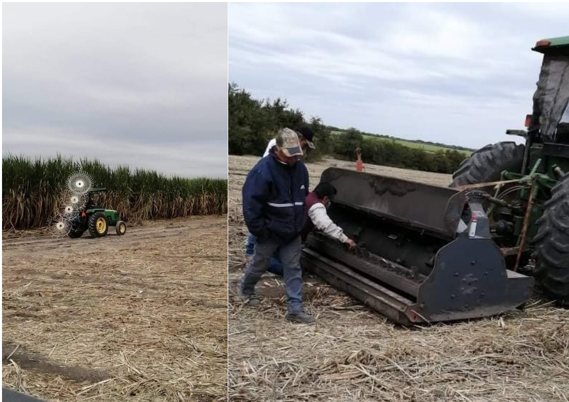
Figura 4. Ahiladora y desmenuzadora para agricultura regenerativa de caña de azúcar en Ciudad Valles, San Luis Potosí.
