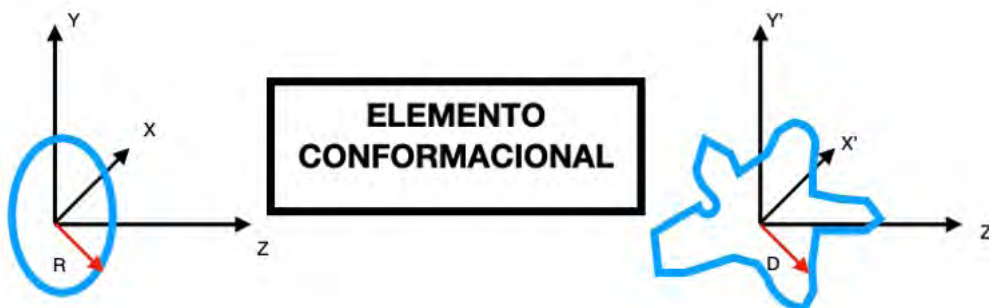
Figura 1.10: Esquema de conformación de haces sin pérdidas donde observamos como a partir de un haz de entrada y un elemento conformacional obtenemos un haz de salida diferente al haz de entrada
