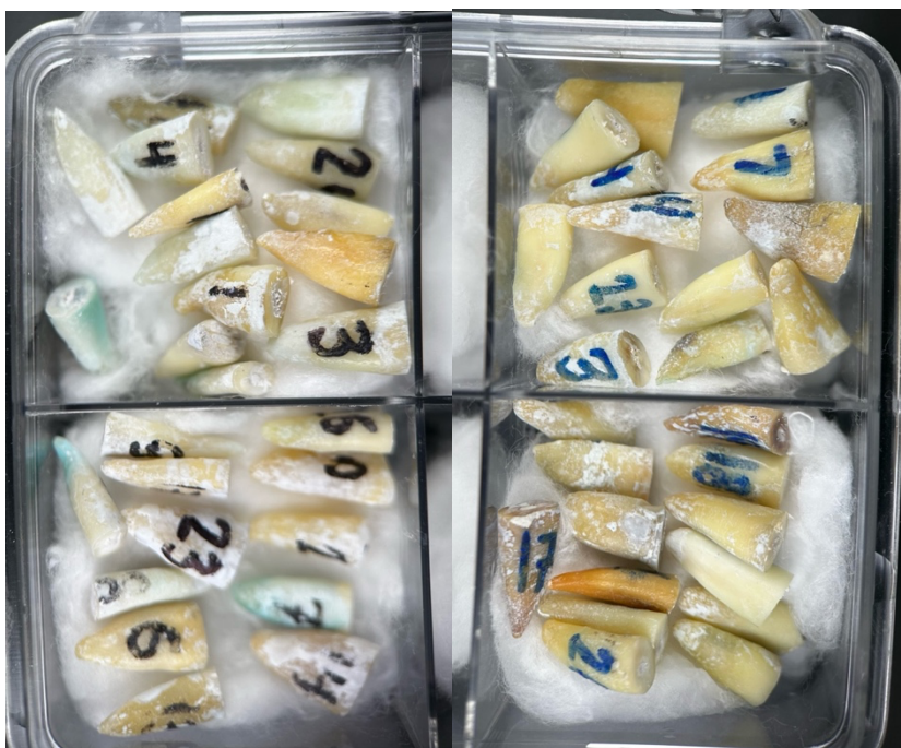
Ilustración 10. Incubación de las muestras Fraguando en humedad relativa
