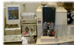
EAA (PERKIN ELMER 3110), con generación de hidruros (Analyst 100-FIAAS), celda de cuarzo (900°C) y gas acarreador argón.
