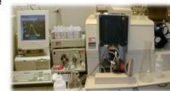
EAA (PERKIN ELMER 3110), con generación de hidruros (Analyst 100-FIAAS), celda de cuarzo (900°C) y gas acarreador argón.
