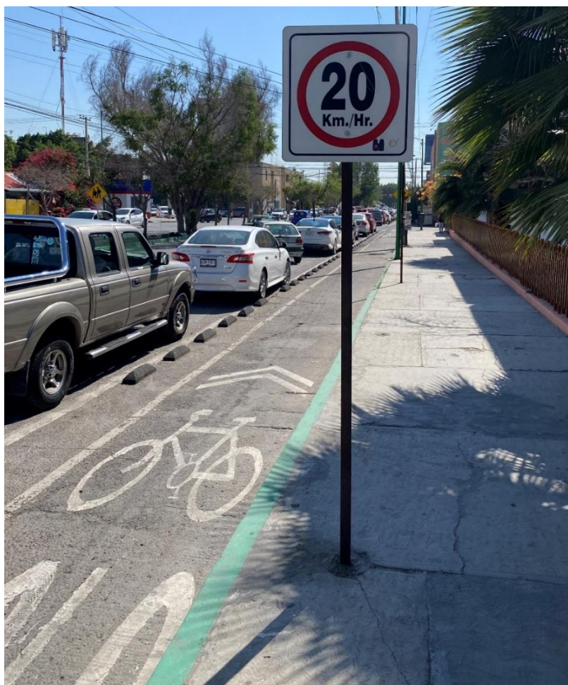
Ilustración 15.- Ciclovía segregada de la Av. Himno Nacional
