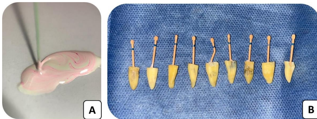
Figura 6 Obturación de muestras con cementos selladores previamente mezclados con Rodamina B.
