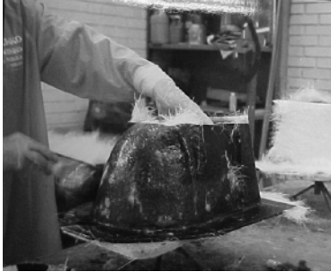
Fabricación de molde de fibra de vidrio para realizar en cemento un modelo de taza para letrina seca de DESICA.
