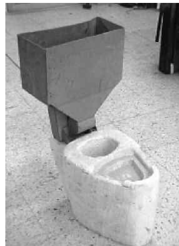
1 Modelo de la nueva taza de letrina seca desarrollada por el Ing. Jean Fritche. Cuyo Objetivo es satisfacer los deseos de quienes quieren usar una taza más parecida ala empleada el el water closet
