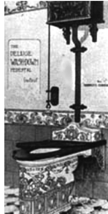
WC: Water closet (esp. Cerrado o sellado con agua) referente a la técnica de sellar la tasa sanitaria con agua mediante un artefacto fabricado con cerámica, para no permitir la salida de malos olores de la fosa séptica o cañería. El sistema permite el fácil desalojo de la inmundicia mediante la provocación de una corriente de agua almacenada en la parte posterior, que va parar o a correr en el subsuelo según el tipo de sistema sanitario ya mencionado.
