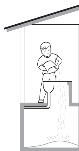
Una necesidad técnica a la que el usuario tiene que acostumbrarse es a cubrir la excreta con un puñado de tierra, ceniza o cal. Operación semejante a jalar la palanca del inodoro para liberar el agua de arrastre.
