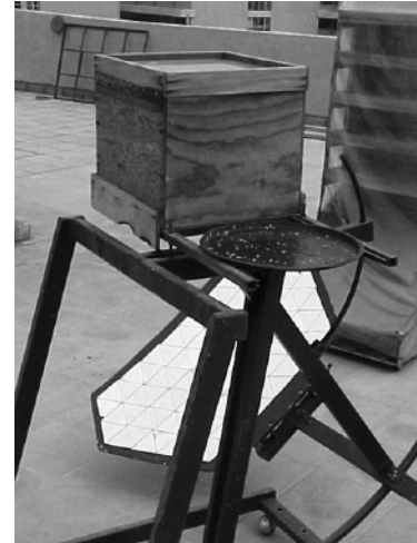
Propuesta de DESICA para ahorro de combustible vegetal o gas. Estufa solar diseñada y probada por el Ing Fritche.
