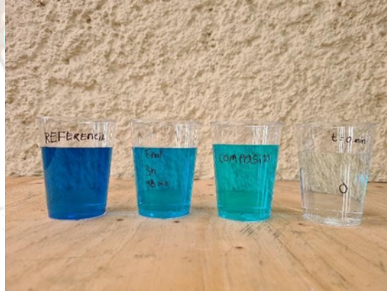
Figura 6: Comparación de color entre la muestra de referencia que representa el reactivo, la muestra final después de la prueba, la muestra del compósito y una muestra al tiempo 0.
