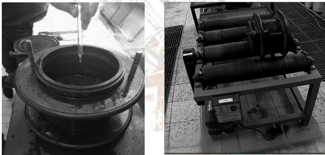
Figura 2.- Molino de laboratorio y banco de rodillos (Elorza, 2021).
