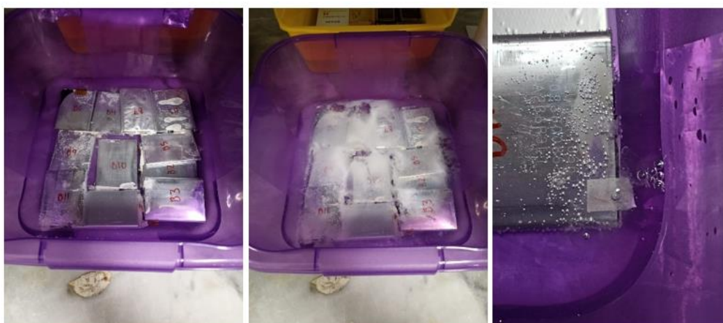
Figura 5. Descarga de las baterías
