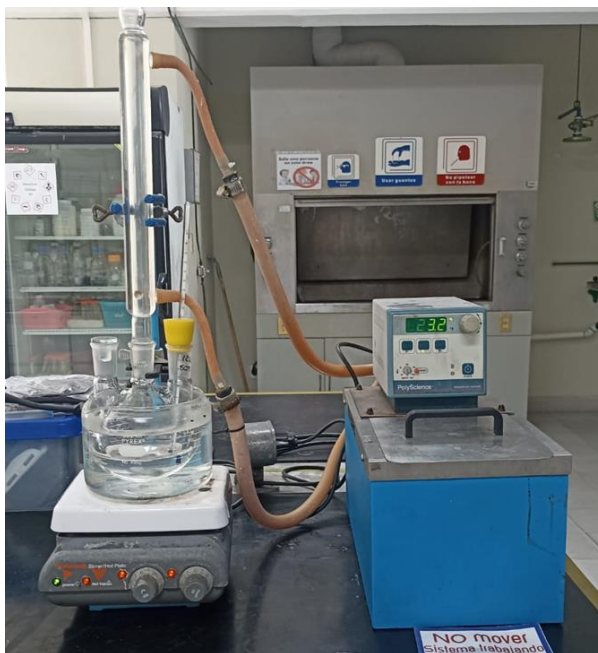
Figura 4. Sistema Experimental para lixiviación con ácido oxálico.
