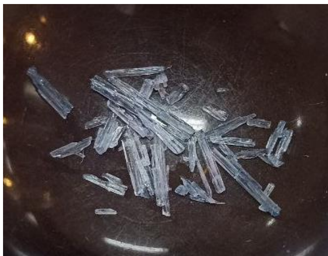
Figura 24. Cristales de ácido oxálico después de la etapa de cristalización a 4 °C.
