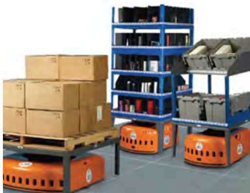
Figura 1. Kiva Robotics. Estos robots se encargan de recolectar los pedidos que recibe la empresa y de llevarlos a su respectiva zona de entrega para que los pedidos puedan ser completados.
