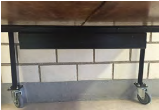
Figura 3.2.2. Contrahierro añadido al estante donde se sujeta el robot móvil
