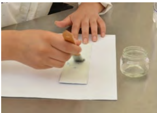
Fig. 5 Fotografía tomada durante el método de Impregnación sobre el reverso de una probeta. Foto tomada por Verónica Díaz
