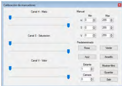
Figura 3.5.3. Ventana de calibración de cámaras. En esta ventana se ajustan los valores que permiten a las cámaras obtener la mejor captura de las marcas visuales
