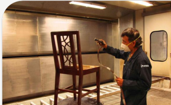
Foto. Aplicación de laca (silla Venecia)
